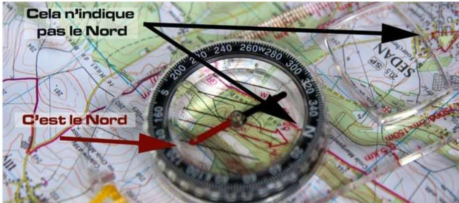
Sur une boussole, le nord est donné par la flèche rouge et non pas par la lettre « N » sur le socle tournant de la boussole, ou la flèche sur le plateau en plastique, qui ne sont que des points de repère
